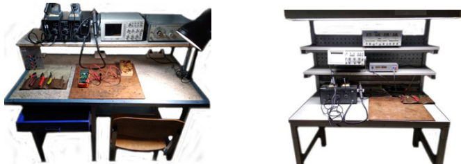
Рис. 11. Варианты конструкции рабочего стола монтажника радиоаппаратуры
