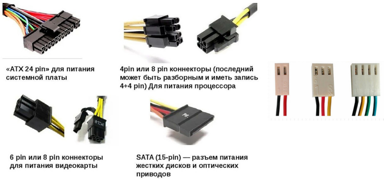
Рис. 62. Внутриблочные плоские разъемы для подключения комплектующих
